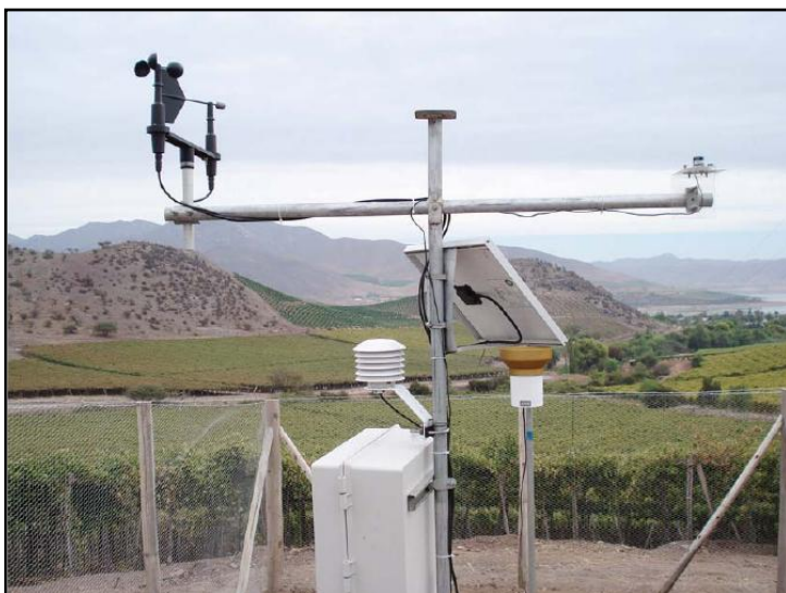
Foto 1.- Estación Meteorológica Automática instalada durante el Proyecto SIAR Limarí.
