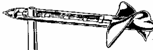
a: Esquema de Molinete hidráulico.
