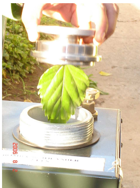
Figura 4: Colocación de la Tapa de la cámara con la hoja ya fijada dentro de la cámara de presión.
