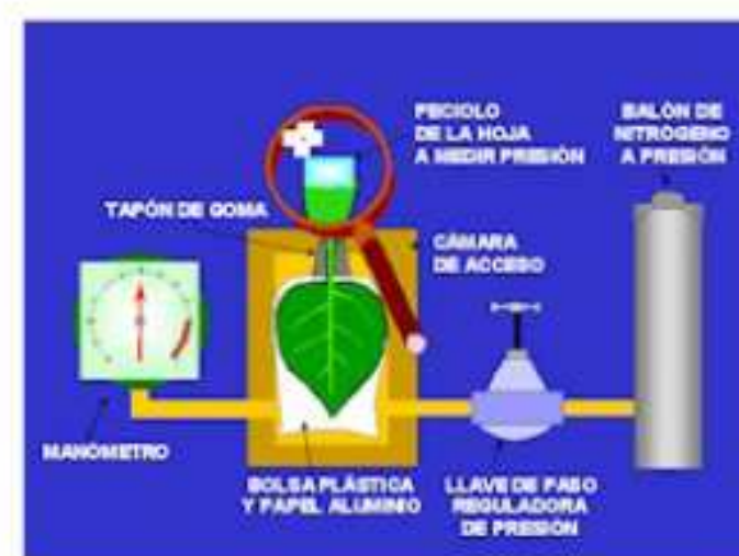
Figura 2: Esquema que muestra el funcionamiento de la Bomba Scholander.
