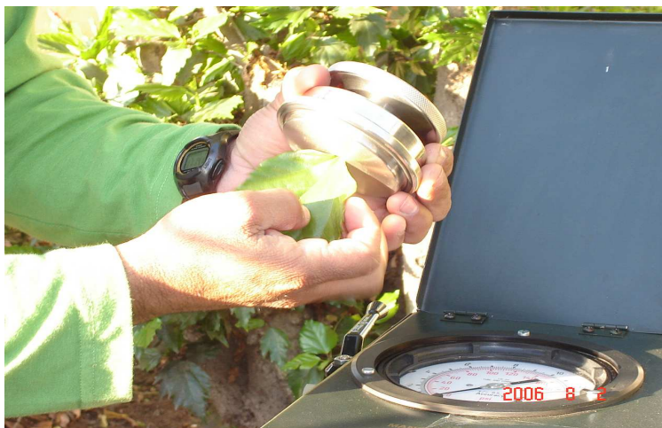
Figura 3: Colocación de la hoja del frutal a evaluar, en el anillo superior de la tapa de la cámara de presión.
