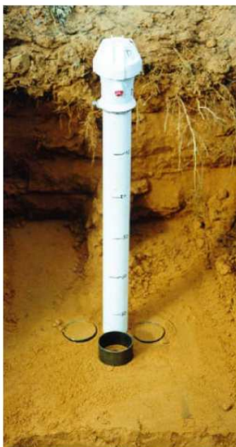
Figura 5: Localización de anillos para el muestreo de suelo, para determinación de humedad gravimétrica y efectuar la calibración del DIVINER 2000.
